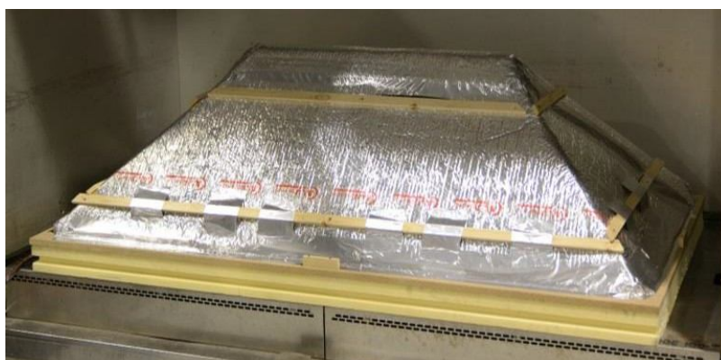
Rysunek 11 - Konstrukcja zaizolowana 1 warstwą materiału Aluthermo Quattro®
