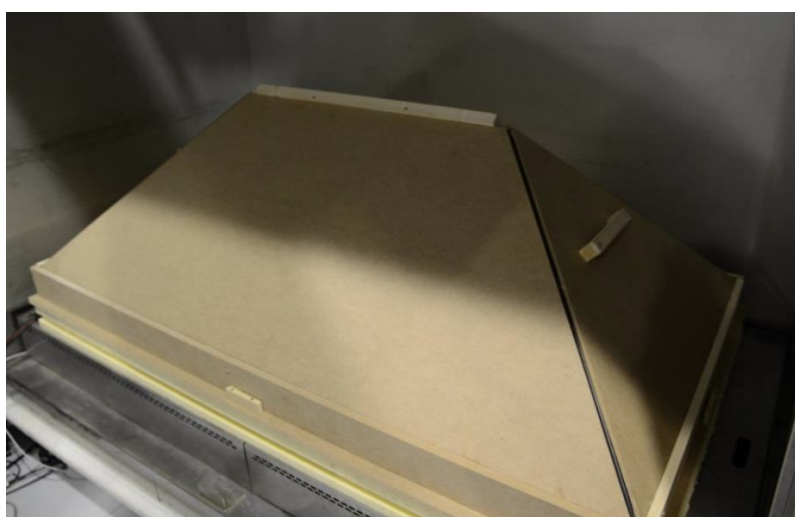
Rysunek 12 - Izolowana konstrukcja pokryta repliką dachu
